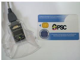
**Figura 1.19** Tarjeta inteligente para certificado electrónico.
