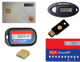
**Figura 1.15** Dispositivos de contraseña de un solo uso.
