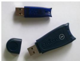
**Figura 1.20** Token USB para certificado electrónico.
