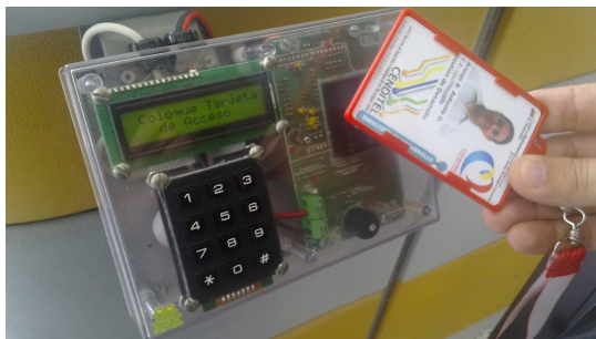
Figura 1.18 Tarjeta y lector de control de acceso físico.
