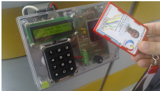
Figura 1.22 Tarjeta y lector de control de acceso físico.
