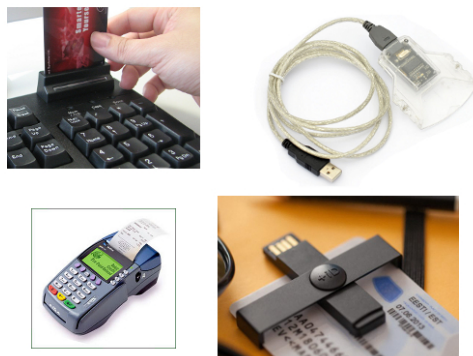
Figura 1.10 Lectores de tarjetas inteligentes de contacto.
