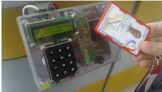
Figura 1.25 Tarjeta y lector de control de acceso físico.
