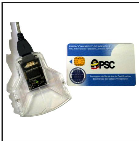
Figura 1.23 Tarjeta inteligente para certificado electrónico.
