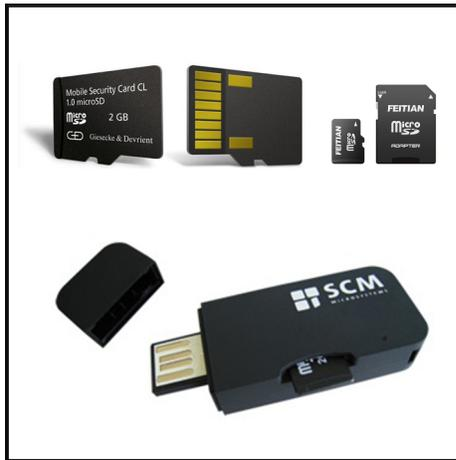
Figura 1.18 Token criptográfico en formato MicroSD y SD.
