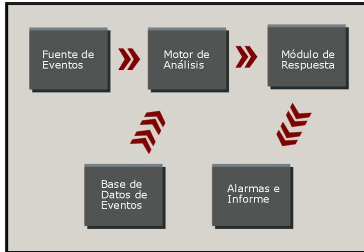
**Figura 2.8** Estructura funcional básica del IDS.
