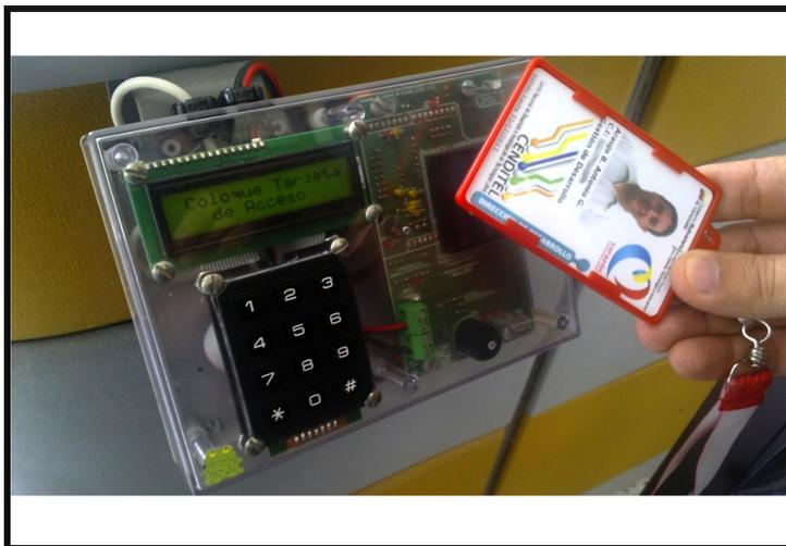
**Figura 1.26** Tarjeta y lector de control de acceso físico.
