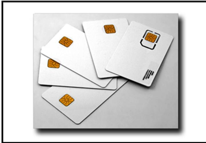
**Figura 1.11** Tarjetas con microprocesador.
