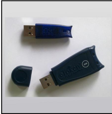
**Figura 1.24** Token USB para certificado electrónico.
