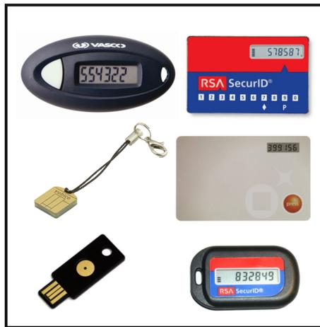
**Figura 1.19** Dispositivos de contraseña de un solo uso.
