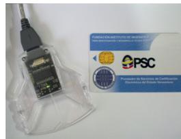
**Figura 1.19** Tarjeta inteligente para certificado electrónico.
