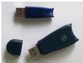
**Figura 1.20** Token USB para certificado electrónico.
