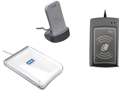
Figura 1.7: Lectores de tarjetas inteligentes sin contacto.
