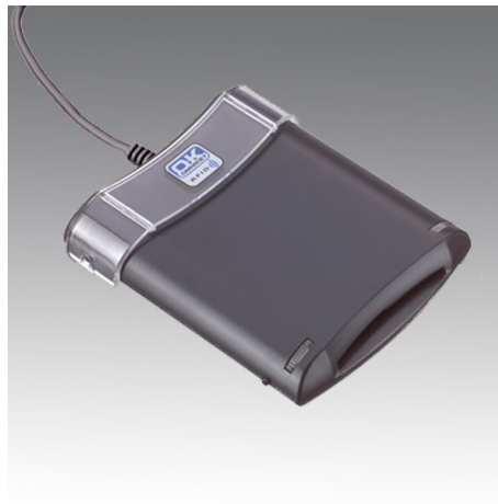
Figura 1.8: Lector de tarjetas inteligentes de interfaz dual.
