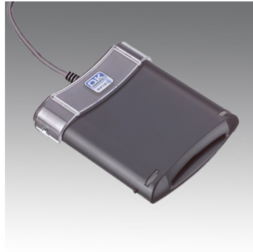
Figura 1.12 Lector de tarjetas inteligentes de interfaz dual.
