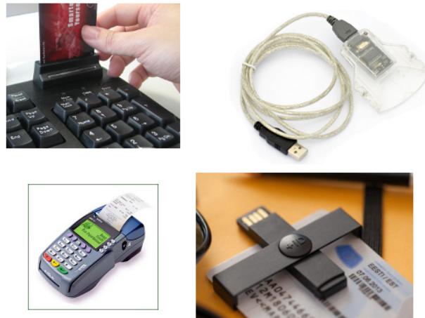
Figura 1.6: Lectores de tarjetas inteligentes de contacto.
